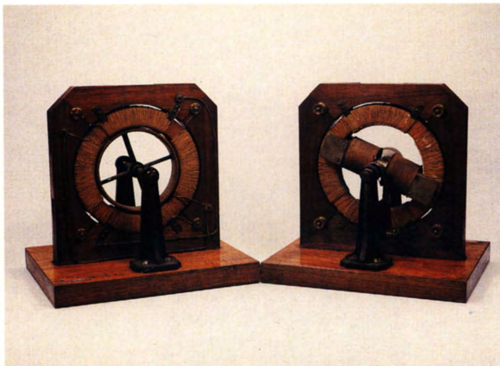
Alternatore e motore bifase XX sec. (vedi p. 180)
