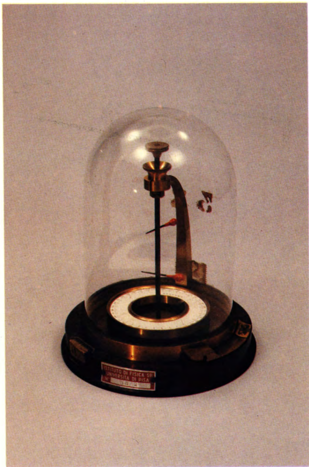
Termometro metallico di Breguet XIX sec. (vedi p. 156)
