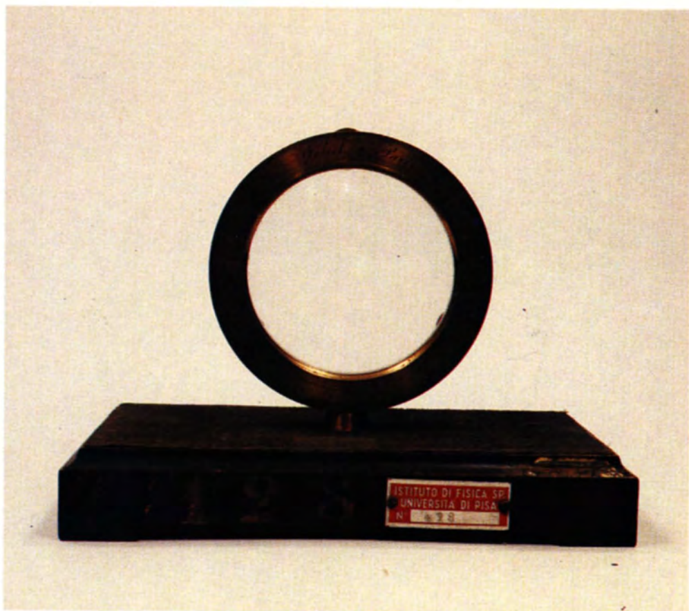
Apparecchio per gli anelli colorati di Newton XIX sec. (vedi p. 136)
