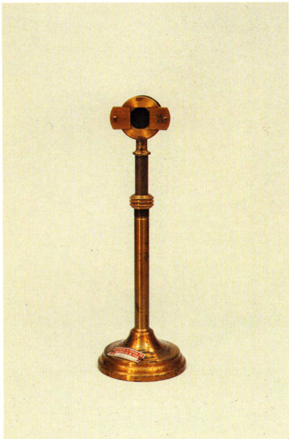
Pila termoelettrica per l'analisi dello spettro XIX sec. (vedi p. 174)
