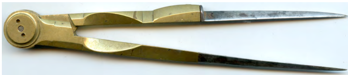
Fig. 7 - Compasso a due punte per prendere le distanze.
