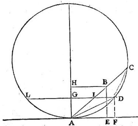
Ma [come subito vedremo] si dimostra che come BE sta a DF così AC sta a DA; dunque, il medesimo mobile percorrerà le linee CA e DA in tempi uguali. Che poi BE sta a DF come CA sta a DA, si dimostra nel modo seguente: Si tracci la corda CD e per i punti D e B si conducano, parallelamente alla AF, la linea DGL, la quale taglia la CA nel punto I e la BH: l'angoloADI sarà eguale all'angoloDCA, poichè insistono sugli archi eguali LA e AD; è inoltre comune l'angolo
