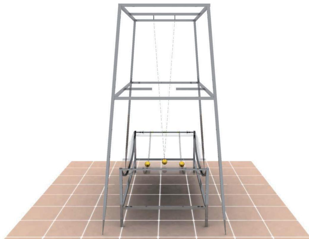
In una lastra di plexiglass larga 1,00 m e lunga 2,00 m, con spessore 0,015 m, sono praticate simmetricamente - nel senso della lunghezza - due scanalature profonde 0,005 m, distanti 0,20 m dai lati. La lastra, così preparata, viene curvata nel senso della lunghezza, secondo un raggio di 2,00 m.
