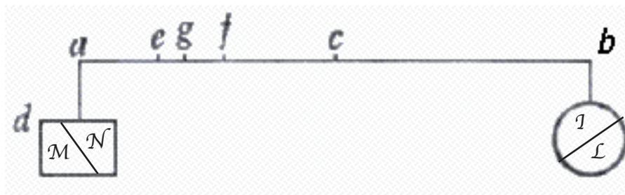
Supponiamo che nel misto  $A$  la parte di oro sia  $I$  e la parte di argento sia  $L$ . Il contrappeso  $B$  è anch'esso costituito di due parti. Quando la misura è fatta in aria,  $M$  è il contrappeso dell'oro  $I$  quando è posto in  $a$  con l'oro  $I$  posto in  $o$ . Nella stessa maniera  $N$  è il contrappeso in  $a$  dell'argento  $L$  posto in  $o$ . Quindi il peso assoluto dell'oro sta al peso assoluto dell'argento come il contrappeso  $M$  al contrappeso  $N$ .
