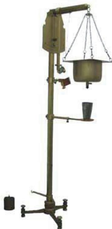
Si può verificare la precisione dell'orologio ad acqua, confrontando il risultato della misura di uno stesso intervallo di tempo, eseguita contemporaneamente con un cronometro digitale e con il metodo galileiano del raccogliere e pesare l'acqua fuoriuscita.
